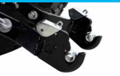
Som ekstra-udstyr med Kat. 1-fanghager på liftarmene.
