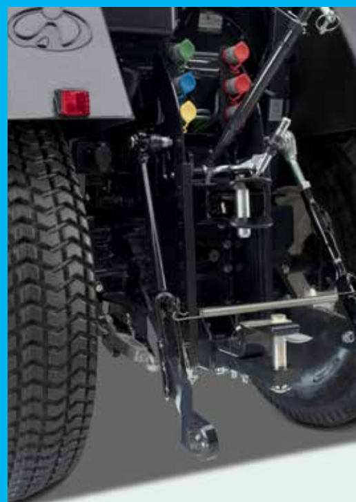
Som ekstra-udstyr med Kat. 1-fanghager på liftarmene.
