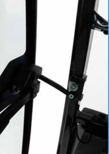
Dørholder til fastholdelse af døren i åben position
