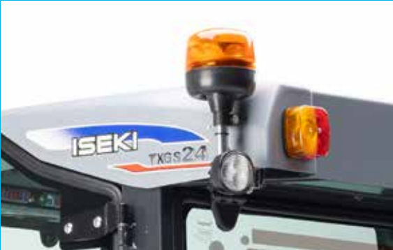
Nedfældeligt rotorblink (LED- eller H4-udgave)
