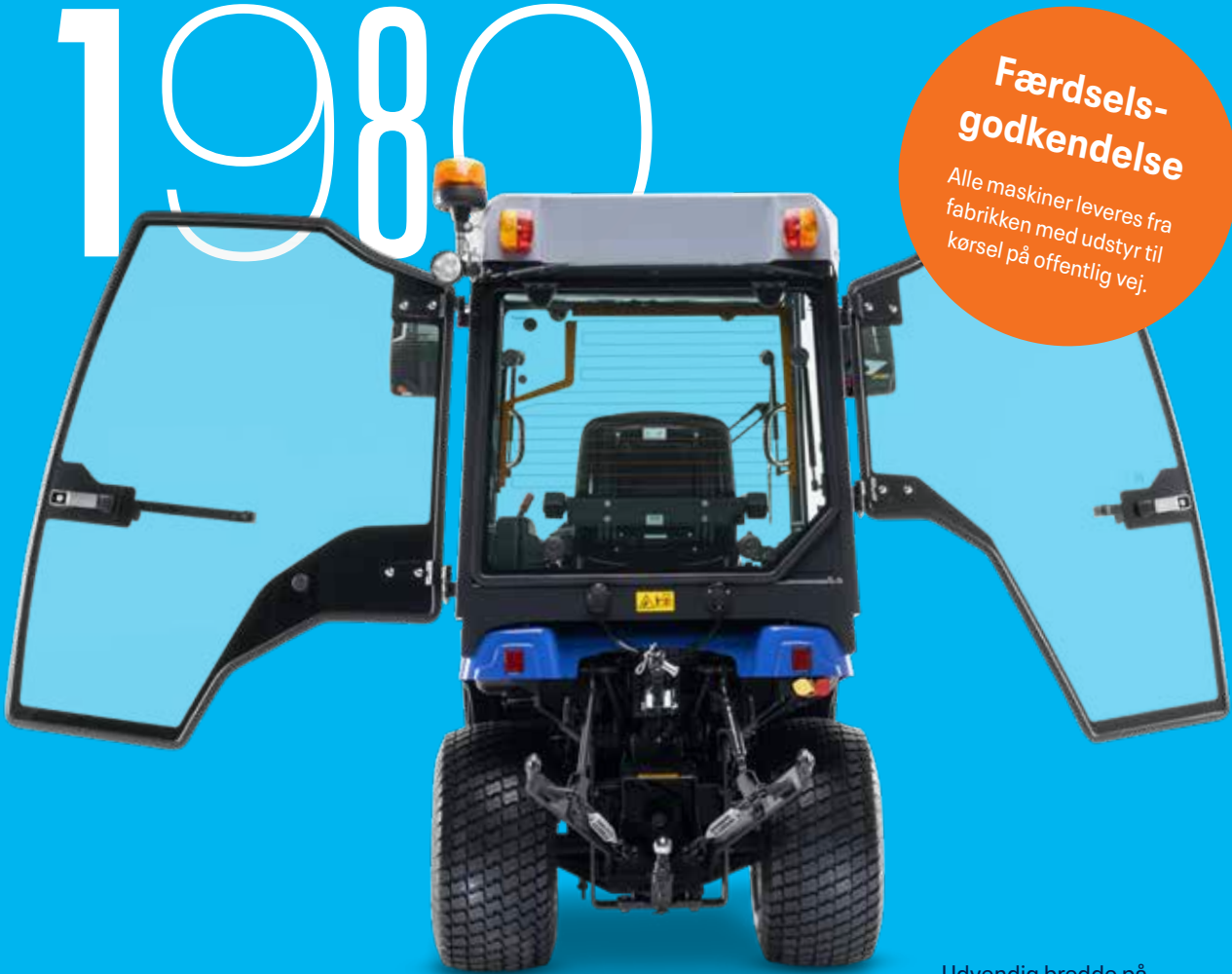
Udvendig bredde på 1.135–1.220 mm (afhængigt af dækmontering)
