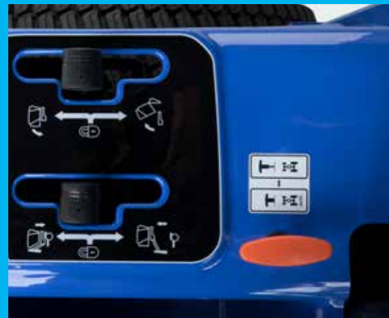
Mekanisk firehjulstræk, der kan indkobles automatisk eller permanent manuelt. Betjenes nemt fra førersædet via et trækhandtag i højre skærm.
