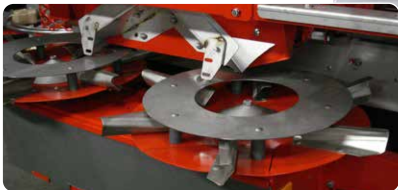
Specialudviklede H-spredeskiver til spredning af urea, kali og svovlsur ammoniak.
