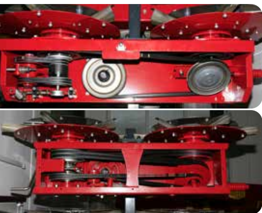
Spredesystemer med kileremstransmission
