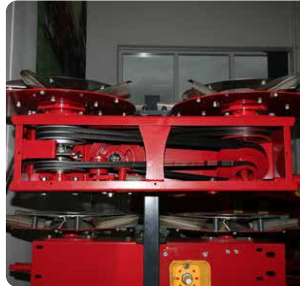
Mekanisk transmission med to kileremme, SPC-2.
