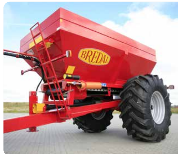
K-spreader med lavt træk og undervogn boltet til rammen
