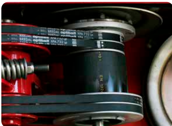
Kantgear til kileremstransmission
